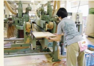
おおまかに家具のパーツとなる部材を切り出します。機械で切断しますが、サイズの微調整は人間が行います。
